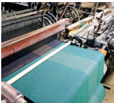
はたや 旧浜北区内の織屋池沼織工房で50年以上稼働している自動織機
